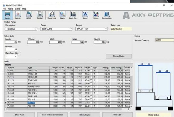
Для подбора стеллажей применяют программный продукт, благодаря которому возможно смоделировать практически любую конструкцию стеллажа под имеющиеся габариты аккумуляторного помещения.
